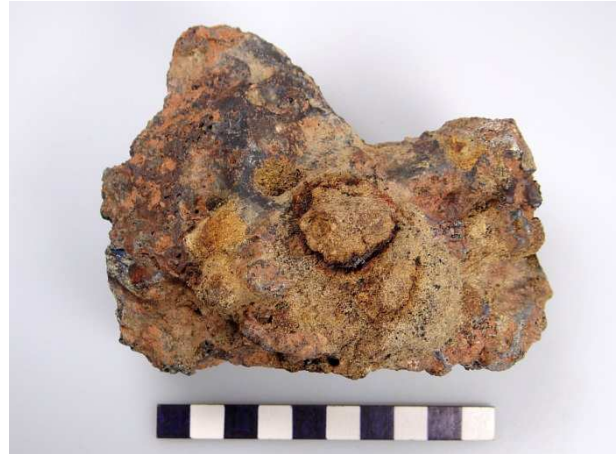
Afb. 5b: binnenzijde van ovenwand V246. De wand is sterk gesinterd en deels met roestige slak bedekt. De schaalverdeling is in cm.
