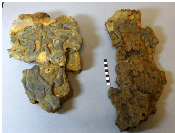
Afb. 2a: tapslak V204. Links het 7 kg fragment, rechts een slak van bijna 5 kg en een restlengte van 44 cm. Aan de bovenkant is leem van de ovenwand zichtbaar. De schaalverdeling is in cm.
