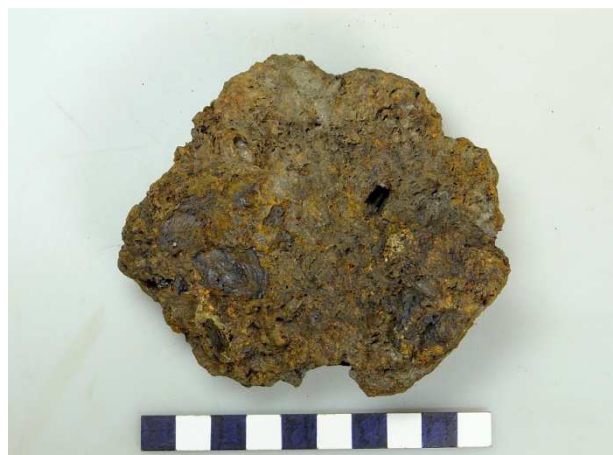
Afb. 3a: houtskoolrijke ovenslak V204. Het fragment is sterk roestig. De schaalverdeling is in cm.
