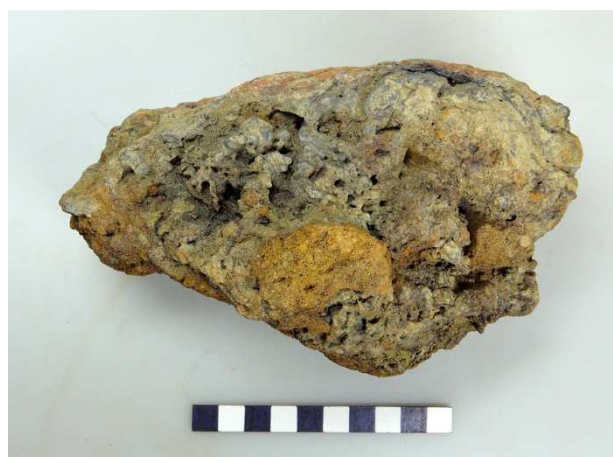
Afb. 4a: onderzijde van ovenslak V728. De slak is deels tussen houtskool door gedruppeld. Langs de bovenrand is oranje gebrande leem van de ovenwand te zien. De schaalverdeling is in cm.
