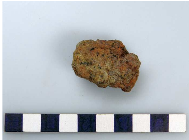
Afb. 6b: als ovenslak geïnterpreteerd fragment (V690). Het stuk heeft een meer slakachtig oppervlak dan V491. De schaalverdeling is in cm.
