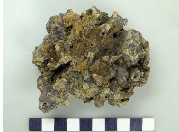
Afb. 7b: onderzijde van ijzerrijke smeedslak V614. De slak is tussen houtskool door gedruppeld. De schaalverdeling is in cm.
