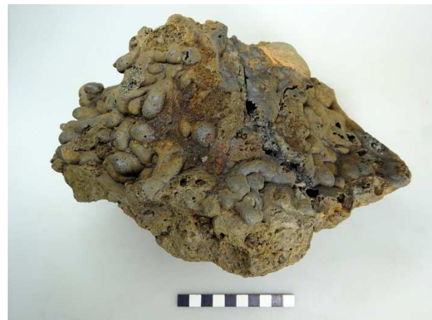
Afb. 2b: tapslak V204. De slak is in meerdere lagen over elkaar uit de oven gevloeid. De ovenwand is rechtsachter te zien. De schaalverdeling is in cm.
