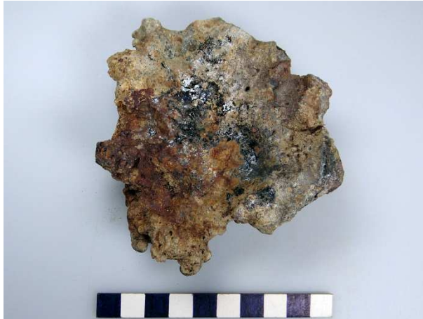
Afb. 7a: bovenzijde van ijzerrijke smeedslak V285. Aan de rechterzijde stond het hitteschild met daarachter de blaasbalg. De schaalverdeling is in cm.
