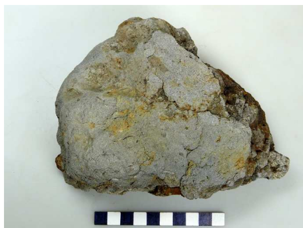
Afb. 4b: onderzijde van ovenslak V204. Hieraan hecht lichtgrijs gereduceerd zandige leem. De schaalverdeling is in cm.
